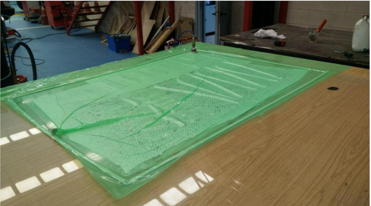
Figura 14.1.1.: Bolsa cerrada con las costillas en el interior
