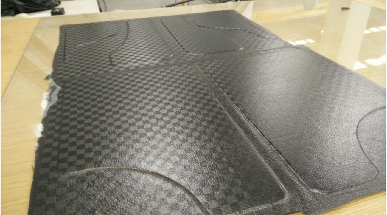
Figura 14.2.1.: Derivas laterales laminadas con fibra 'especial'
