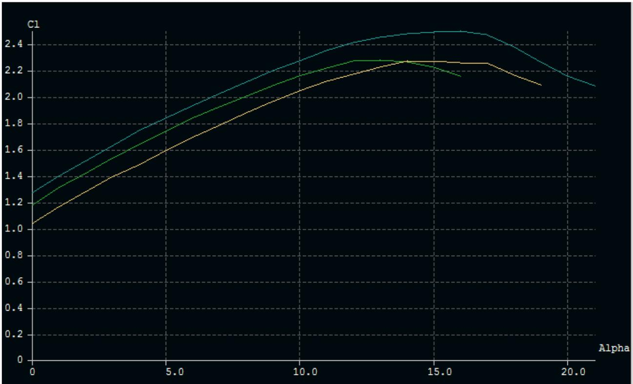
Figura 5.3.4.:  $C_L - \alpha$ . En naranja el perfil S1223 8-30 16-17, en azul el perfil S1223 10-40 13-18 y en verde el S1223
